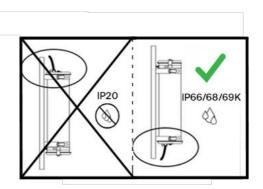
Vérifier impérativement la correcte fermeture des organes d'étanchéité du produit, y compris pour les produits livrés précâblés.
